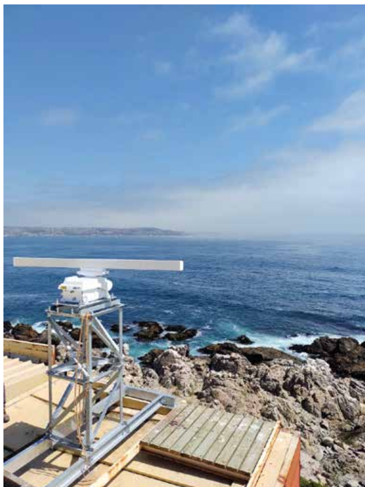
INSTALACIÓN DE RADAR BANDA X sobre techo edificios de ECIM para medición de oleaje y corrientes superficiales.
